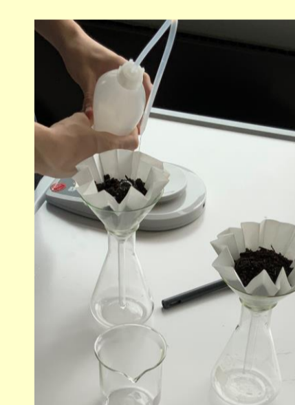
Abb. 7 Messung der Wasserhaltefähigkeit
