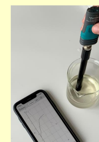
Abb. 6 Messung der Leitfähigkeitswerte
